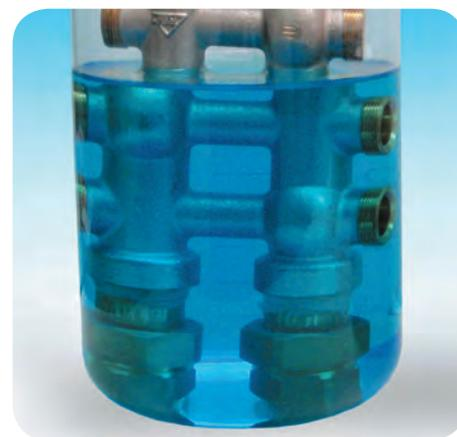
Collettore di ottone cromato protetto con 1,5 % di FILMAX in acqua di rete, durezza  $30\text{ }^\circ\text{f}$ .
