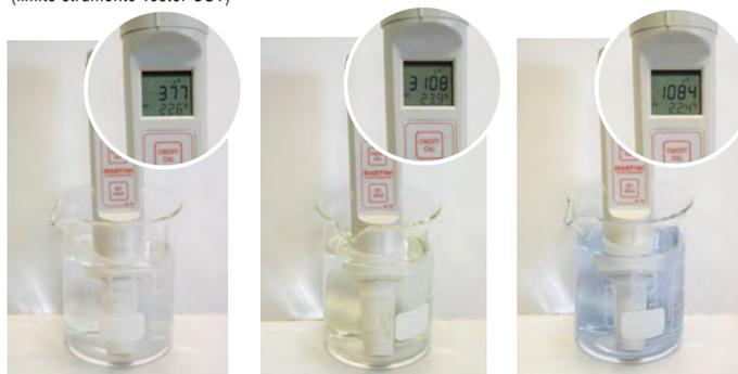
Verifica della Conducibilità Elettrica per mezzo di un conducimetro TESTER CST, rispettivamente di semplice acqua di rete, acqua di impianto trattata con Antinex+Thermakil® al 3 % e acqua di impianto trattata con Filmax+Thermakil® al 2 %.
