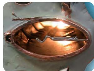
Scambiatore decapato con FERRONEX al 1,5 % in 3 ore
