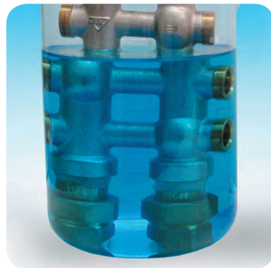
COLLETTORE DI OTTONE CROMATO PROTETTO CON 1,5% DI FILMAX IN ACQUA DI RETE, DUREZZA 30^\circ\text{f} . CHROME PLATED BRASS COLLECTOR PROTECTED WITH 1.5% OF FILMAX IN THE SYSTEM WATER, 30^\circ\text{F} HARDNESS.
