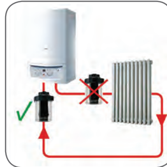
Fig. 6 - Corretta installazione di MAG-NEX HP
