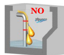
Installazione errata Wrong installation
